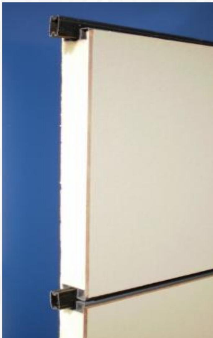
Los paneles están dotados de un bastidor perimetral de PVC con diseño adecuado para el encaje e inserción de perfiles conectores del mismo material, que nos aseguran la continuidad de la solución y su estanqueidad frente a la acción del agua exterior.
