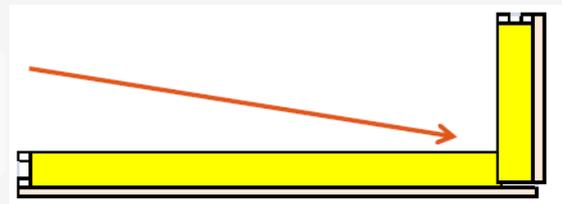
La unión entre paneles se reforzará aplicando un adhesivo **elastómero PLYMER AS-50** o similar, que actúe como sellador.
